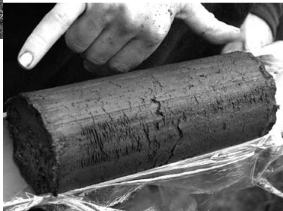
Foto: Vzorek z vrtu skrz osmimetrovou vrstvu rašeliny (Mothhäuser Heide)
